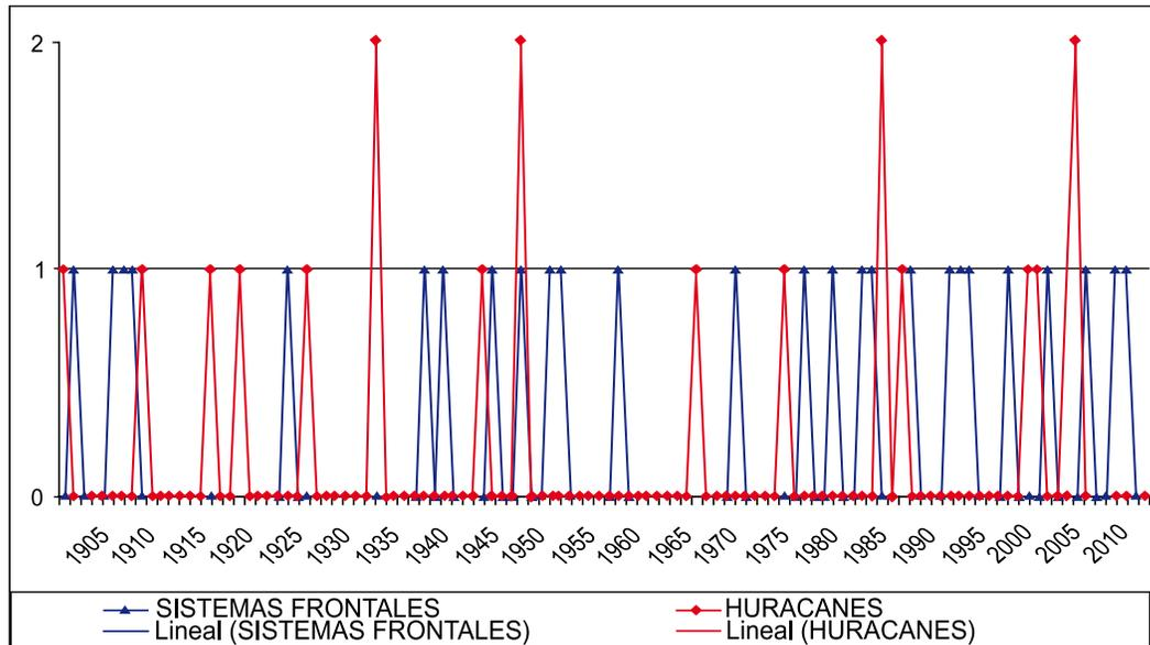
**Figura 2.42.** Inundaciones moderadas y fuertes en el Malecón Habanero (1901-2011), con inclusión de las tendencias lineales
