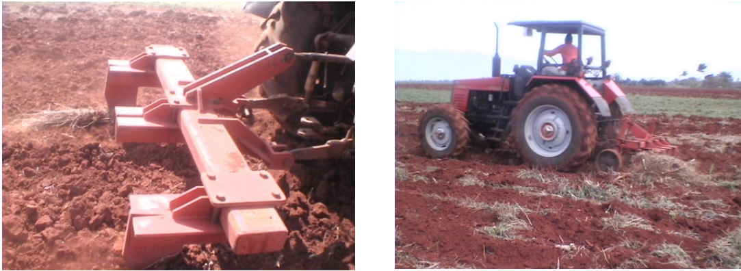
Figura 39. Labores de preparación de suelos con tecnologías conservacionistas (tiller y multiarado) en Güira de Melena.
